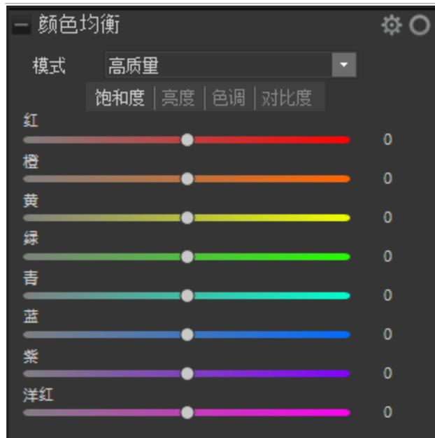
通过向右拖动滑块以增加强度或向左拖动以降低强度来分别调整每种颜色。您还可以通过在字段中输入数值来进行精确调整。或者将光标放置在图像上直到出现双向箭头的图标，以便选择某种颜色来调整。然后单击并上下拖动，可调整位于双向箭头图标下方的颜色。移动光标时，将自动调整受影响的颜色滑块。
